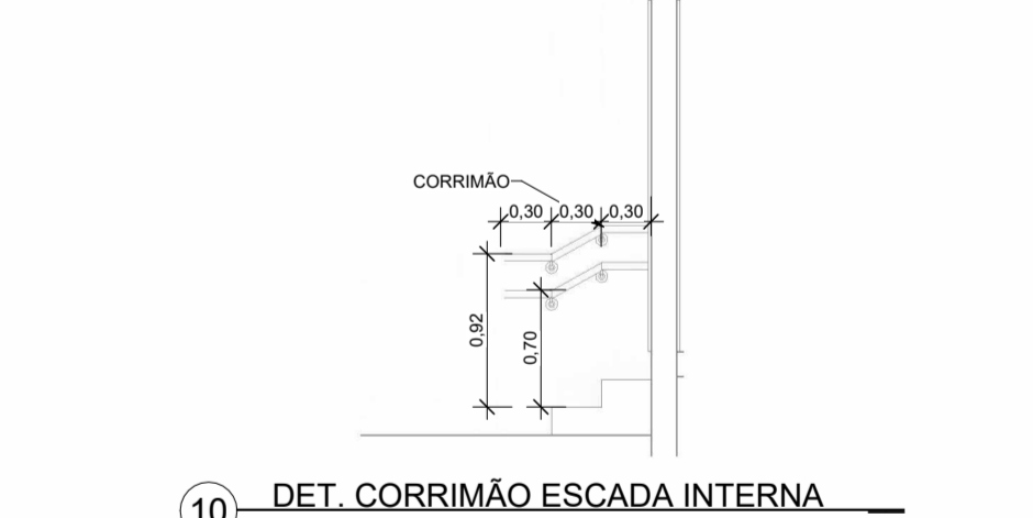
10 DET. CORRIMÃO ESCADA INTERNA ESCALA: 1:50
